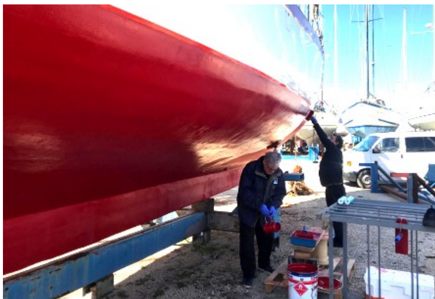
Ponçage de la coque, pose de l'antifouling
