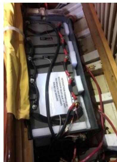
Entretien et réparation des circuits électriques, pose de nouvelles batteries
